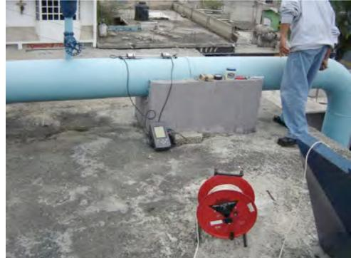
Si durante la medición en un cárcamo o tanque, el nivel del agua cambia de posición significativamente, entonces la medición del nivel de succión debe hacerse de manera simultánea con las mediciones de caudal, presión y parámetros eléctricos. El valor podrá ser negativo o positivo, lo cual depende de si el nivel se encuentra por debajo o por encima del nivel de referencia.
