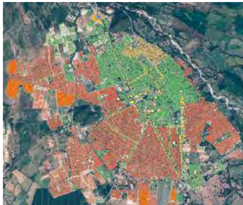
GRÁFICO 58. Vulnerabilidad de los elementos expuestos al viento, de menor vulnerabilidad (forjado de concreto) al más vulnerable (lámina de zinc)
