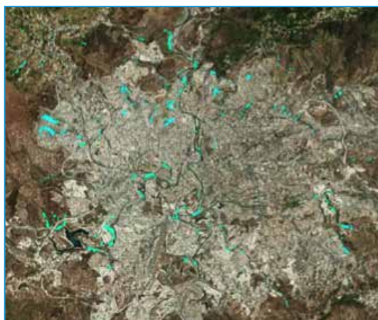
Deslizamientos activos en zonas de inundaciones en la zona urbana
