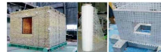
Figura 43. Imagen de la tecnología del uso de las mallas de banda de polipropileno (pp-band), una medida de bajo costo para realizar el reforzamiento de construcciones, desarrollado en Japón
